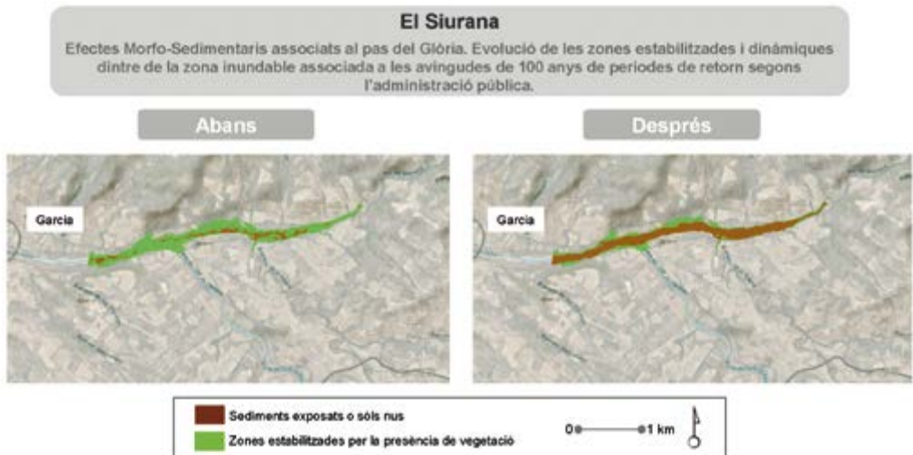
Figura 15. Efectes morfosedimentaris del Glòria al riu Siurana: processos erosius i de sedimentació que afavoreixen l'aparició d'unitat morfològiques actives i la reconexió transversal de les lleres.
